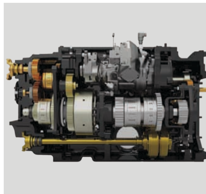
Transmission CVX – une conduite en continu entre 0 et 50 km/h.
