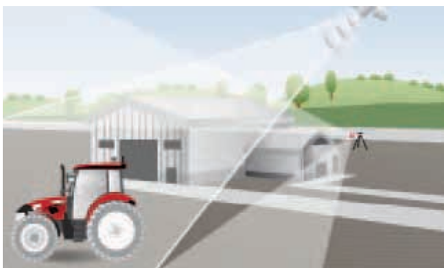
Le xFill comble les lacunes du signal RTK jusqu'à 20 minutes.
