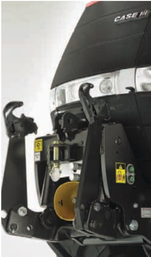
Un attelage avant parfaitement intégré avec une puissance de levage de 5 000 kg.
