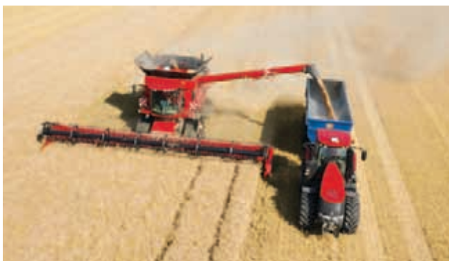
AFS AccuGuide™ : un guidage basé sur GPS ou GLONASS pour une précision ultime indépendante des conditions de cultures. Des niveaux de précision disponibles allant jusqu'à 2,5 cm.
