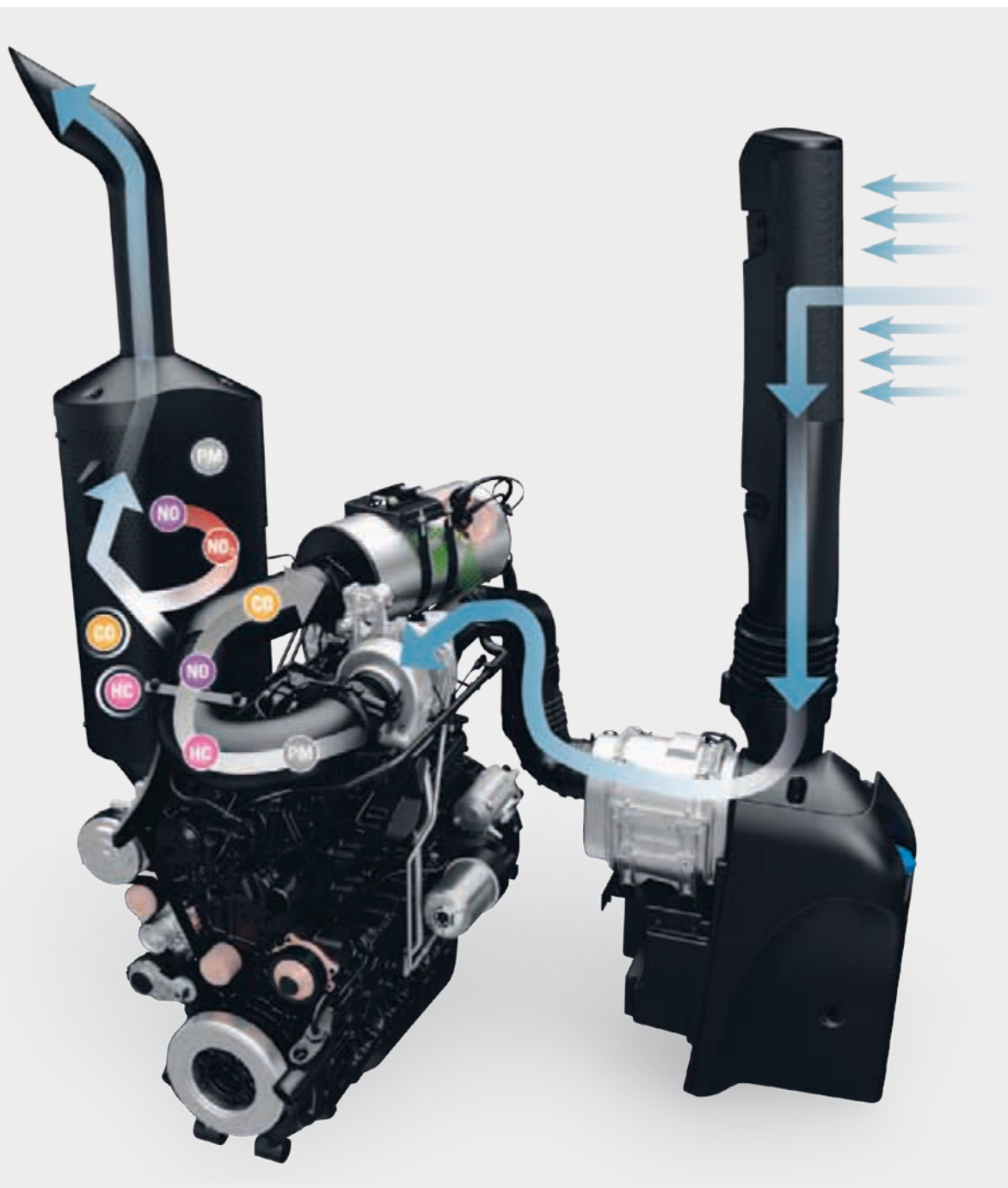
Une interaction parfaite entre la transmission et le moteur – Des moteurs FPT Industrial fait en interne.
